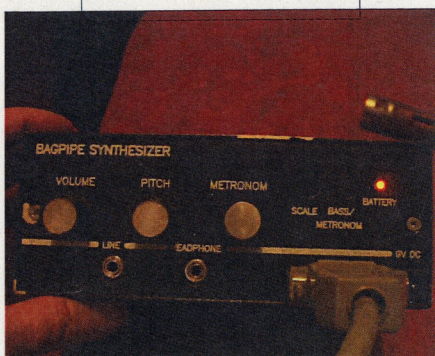
バグパイプ・シンセサイザーの本体、これに指穴つきの管の一部をつないで練習する
